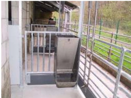
Sauen und Ferkel können über zwei Klapptüren pro Bucht (s. Abb.5) den überdachten Außenbereich (s. Abb. 6) erreichen. Ein 2 %iges Beton-Fußboden-Gefälle zum davor liegenden Entmistungsgang soll den Abfluss von Urin und Tropfwasser von den Tränken verbessern und beschleunigen, damit u. a. dem immer wieder beobachteten Urin-Saufen der Ferkel vorgebeugt wird.
