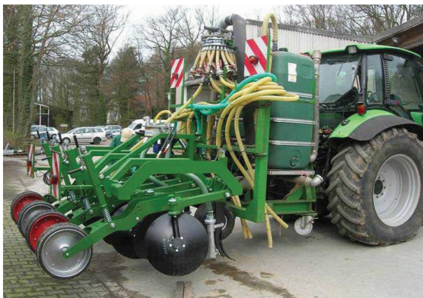
Abbildung VI /7: Versuchsgerät zur Gülledüngung
