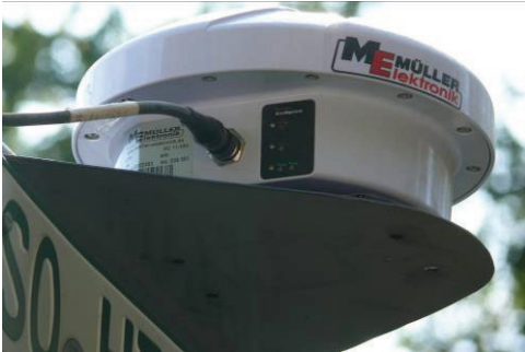
Abbildung VI /8: Schlepper mit GPS-Empfänger
