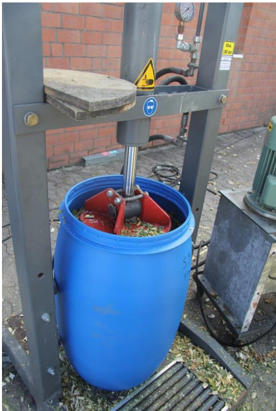
Abb. 3.2.1.1: Bestimmung der Verdichtbarkeit mittels hydraulischer Presse
