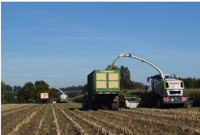
Abb. 3.2.1: Parallele Ernte mit zwei Häckselketten
