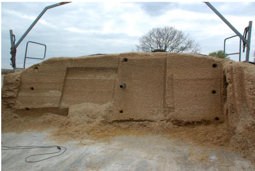
Abb. 3.2.1.3: Verteilung der Probenahmepunkte zur Dichtebestimmung an der Anschnittfläche
