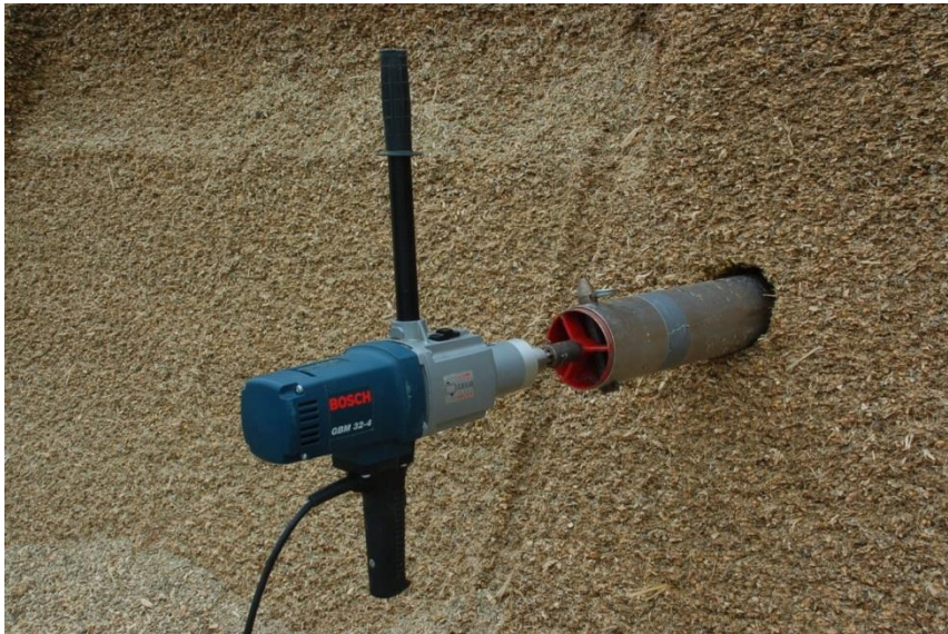
Abb. 3.2.1.2: Bestimmung der Lagerungsdichte im Fahrsilo mittels Bohrkernmethode
